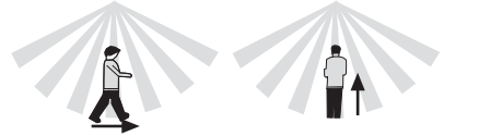
Sensöre teğet yürüme (Normal algılama mesafesi) Sensöre dik yürüme (Düşük algılama mesafesi)
